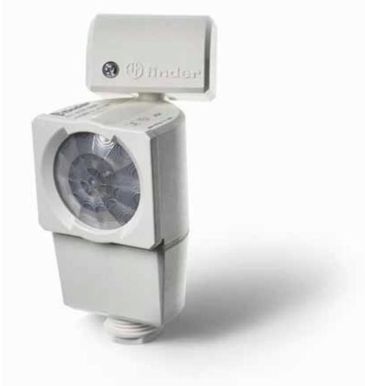
Bewegungsmelder 230 V AC, 1 Schließer 10 A 230 V AC (AC1), max.-Einschaltstrom 100 A - 5 ms, max.-Schaltleistungen bei 230 V AC: AC1-2.300 VA, AC15-450 VA, Glüh- und Halogenlampen-1.000 W, Leuchtstofflampen kompensiert 350-W, Leuchtstofflampen unkompensiert 500 W, mit Lichtsensor 1 - 350 Lux auf Tag oder Nachtfunktion einstellbar und Einschaltwischer-Funktion 10 s bis 12 min. Für Außenmontage, IP54.
